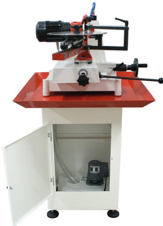
Una vez desembalada la máquina, monte los cuatro pies a la base de la máquina, ponga la bandeja recoge aguas encima y coloque la máquina en los encajes de la bandeja recoge aguas. Fije la máquina mediante los cuatro tornillos suministrados y ponga las 4 tapas de plástico para que no entre agua por el agujero.
