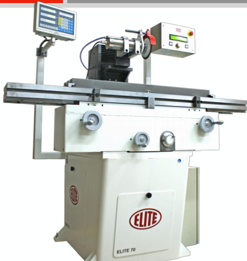
La ELITE 70 es nuestra afladora universal de herramientas de alta precisión y robustez, diseñada para los trabajos más duros, ya que permite cargar hasta 200 kg en la mesa de trabajo, logrando precisión de micras para el afilado o rectificado más exigente de sus herramientas.
