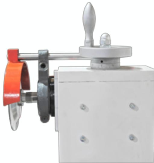
Motor porta-muelas directo con accionamiento de velocidad variable de 3000 a 9000 rpm.
