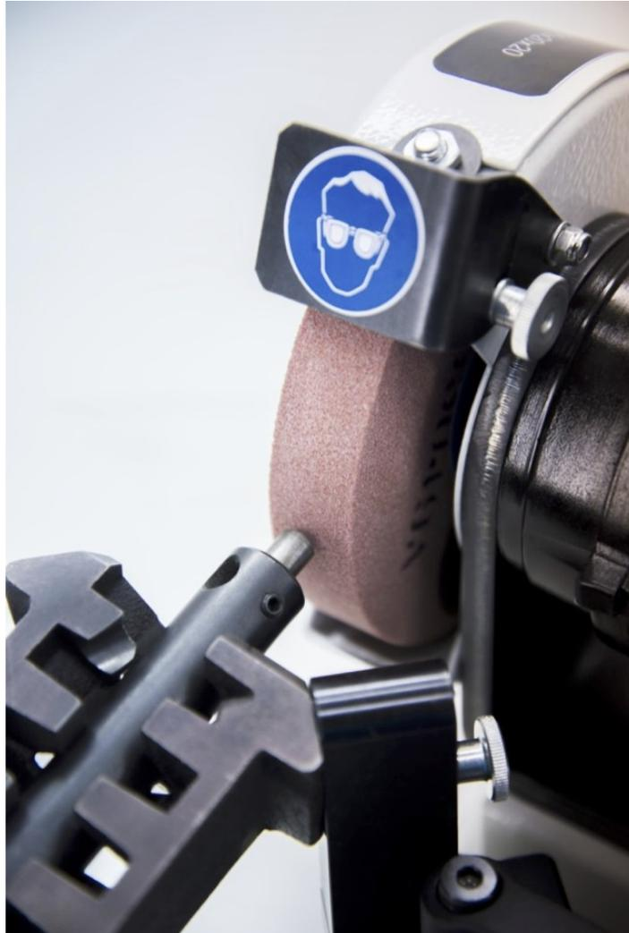
Para realizar el proceso de diamantado, se debe aflojar la leva de posicionamiento del soporte del porta herramientas y fijar la posición en 150°.
