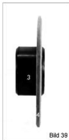
Para muelas de 20 mm. De espesor (fig. 38 ítem 2) se debe utilizar el anillo espaciador de 20 mm.
