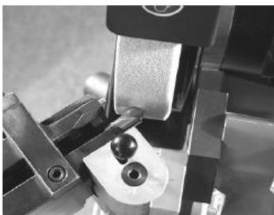
Introducir la broca en el soporte dejando 15 mm. Fuera y posicionar el ángulo de corte paralelo al ajuste del afilado de la broca. (fig. 12 pos. 3) ajustar el soporte a 90° y el ángulo de desprendimiento a 3,2 (aprox.) Mover el avance con la oscilación y afilar una cara. Girar el soporte y afilar la segunda cara.
