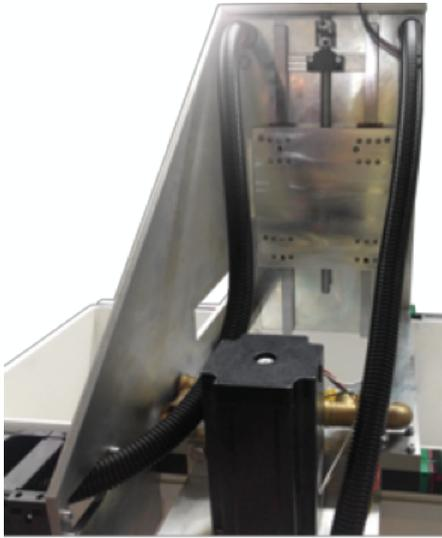
Husillo de bolas en el eje vertical para un movimiento fluido y una precisión de movimiento hacia abajo de 0,001 mm. El husillo de bolas atraviesa la placa del motor, garantizando la máxima estabilidad y rigidez y evitando que entre suciedad por el afilado.
