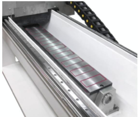
Portacuchillas magnético magnetizable y desmagnetizable desde el panel de control. Misma fuerza de sujeción en el extremo de la placa o en el centro: por estrechas que sean las cuchillas se sujetan perfectamente en el borde de la placa. El sistema de superpolaridad está disponible opcionalmente. Con una fijación aumentada en un 20%.
