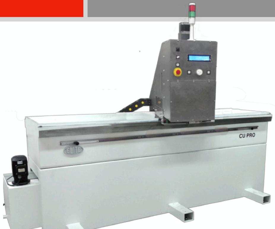
Nuestro modelo ELITE CU PRO es la máquina de fabricación y afilado de cuchillas más avanzada. Cuenta con un cabezal de rectificado diseñado para prevenir la corrosión, equipa un motor de transmisión directa: esto le permite tener un 20% más de potencia del motor en comparación con otros motores que incorporan transmisión por correa.
