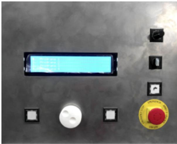
Programa sus propios parámetros de afilado con el panel CNC estándar. Permite realizar y guardar programas, perfecto para el afilado de cuchillos de papel o fabricación de cuchillos.
