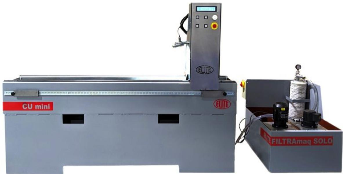
Al equipar la CU mini con un sistema de filtración FILTRAmag SOLO, logra un mantenimiento reducido de la máquina debido a un menor desgaste de las piezas móviles, como cojinetes y guías. Y además afilando tus cuchillas con un refrigerante completamente libre de contaminación y partículas abrasivas, el acabado final de la pieza y su rugosidad será mucho mejor.
