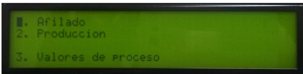
Para programar la operación de producción, vaya a la pantalla de menú LCD. Seleccione el programa: 2. *Producción* (véase fig.7), para configurar parámetros de la operación de producción, pulsando el selector de menú. A continuación, le aparecerá la siguiente pantalla (véase fig. 8).
