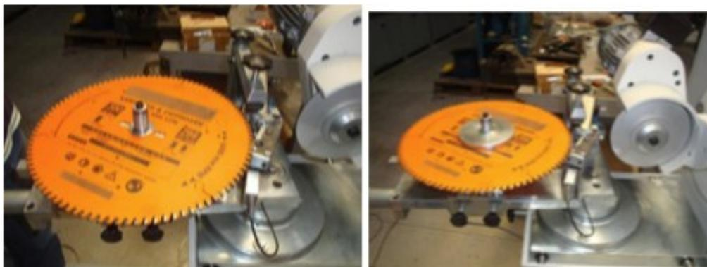
Girar el nonio de ajuste del diámetro hasta que la uña de avance alcance la cara del diente, la dirección de la uña debe estar en una posición centrada en la mitad del diente.
