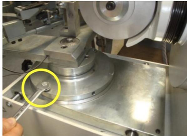
Aflojar los 4 tornillos de sujeción del portasierras.
