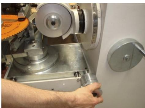
Movimiento de retroceso del cabezal: comprobar la pasada que estamos dando
