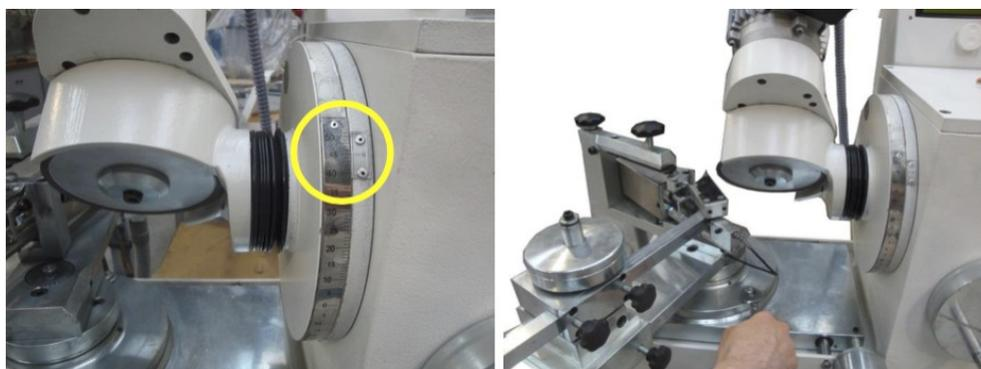
Comprobar que la uña de avance esté en el eje del pivote de fijación, sino ajustarlo por el nonio del diámetro.
