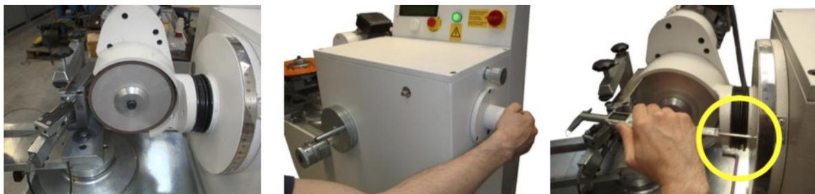
Para ajustar la inclinación del cabezal: aflojar los tornillos de bloqueo y rotar hasta alcanzar el ángulo deseado, entonces apretar de nuevo los tornillos.
