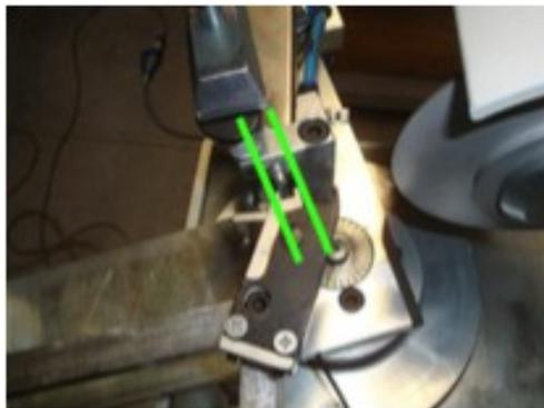
En la pantalla escoja AJUSTE MANUAL y confirme, ATENCIÓN! La muela se pondrá en marcha, contestar SI. Escoger “diente atrás” y confirme. Inténtelo hasta conseguir la posición que se ve a continuación:
