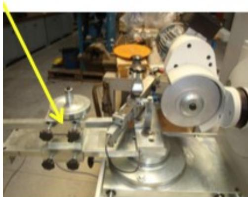
Comprobar que la uña de avance debe estar al final de su recorrido encajado en el pivote de ajuste. Si no ajustarlo mediante el nonio.
