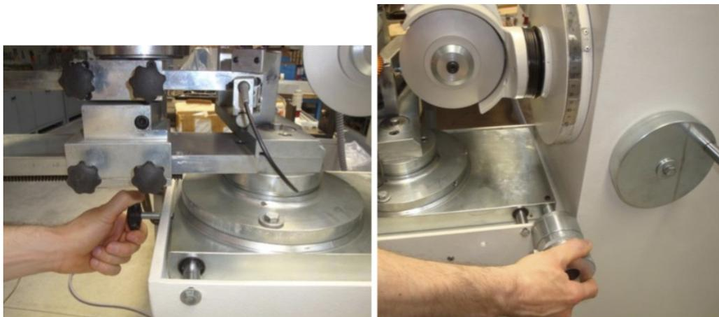
Mediante el botón de control debemos separar el cabezal de la sierra y dar la carga final que queremos dar al afilado (con una cantidad pequeña es suficiente).
