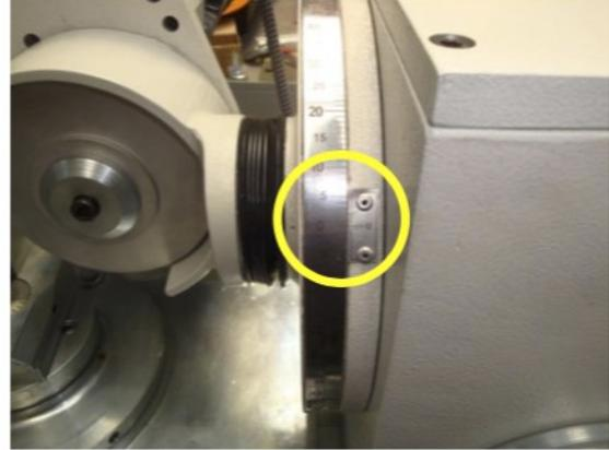
Para ajustar el ángulo del cabezal: aflojar los tornillos de fijación, rotar el cabezal y bloquear de nuevo. Ajustar el ángulo de corte.
