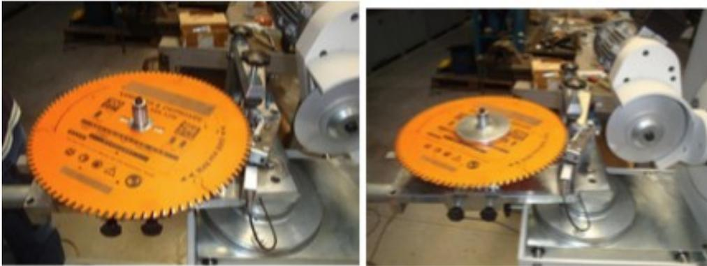
Mediante el nonio del diámetro acercar la sierra hasta que la uña de avance quede en el interior del diente.
