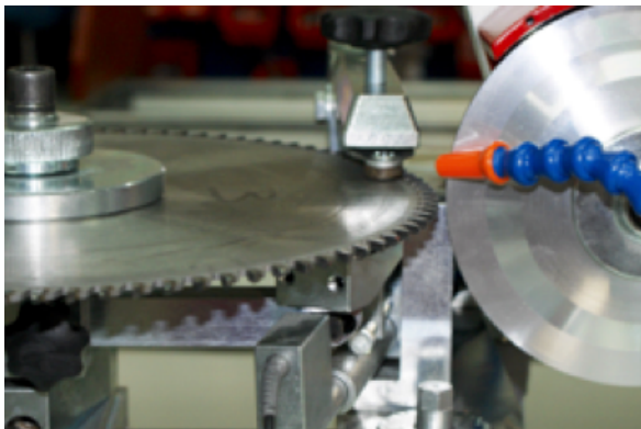
Refrigeración de hoja de sierra circular.
