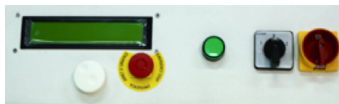
Pantalla LCD para la fácil programación del ciclo de afilado
